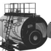
VAPOPRES 3GN Kocioł parowy wysokociśnieniowy trójciągowy Moc: 110 - 19500 kW Ciśnienie pary: 11,7; 15 bar Produkcja pary: 1,6 - 28 t/h
