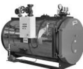
VAPOPRES LVP Kocioł parowy niskociśnieniowy Moc: 136 - 2086 kW Ciśnienie pary: 0,98 bar Produkcja pary: 150 - 2990 kg/h
